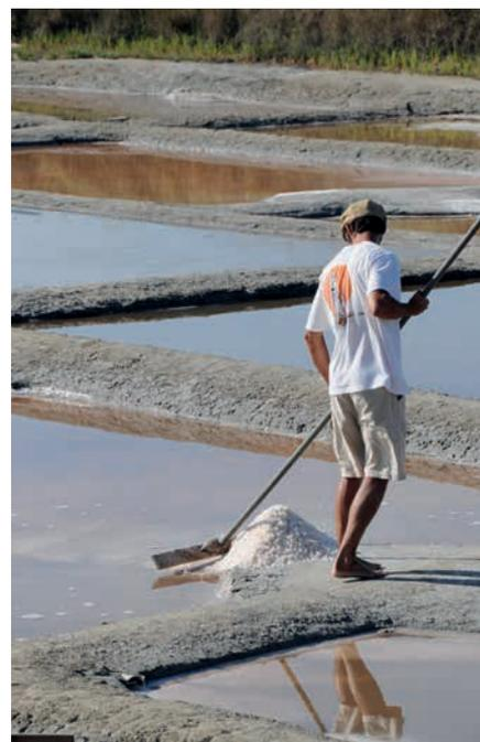
Les **marais salants** fonctionnent grâce à une série de **bassins successifs**, comme à **Guérande** (Loire-Atlantique). En circulant d'un bassin à l'autre, l'eau s'évapore de plus en plus, la concentration en sel augmente et le sel cristallise.
