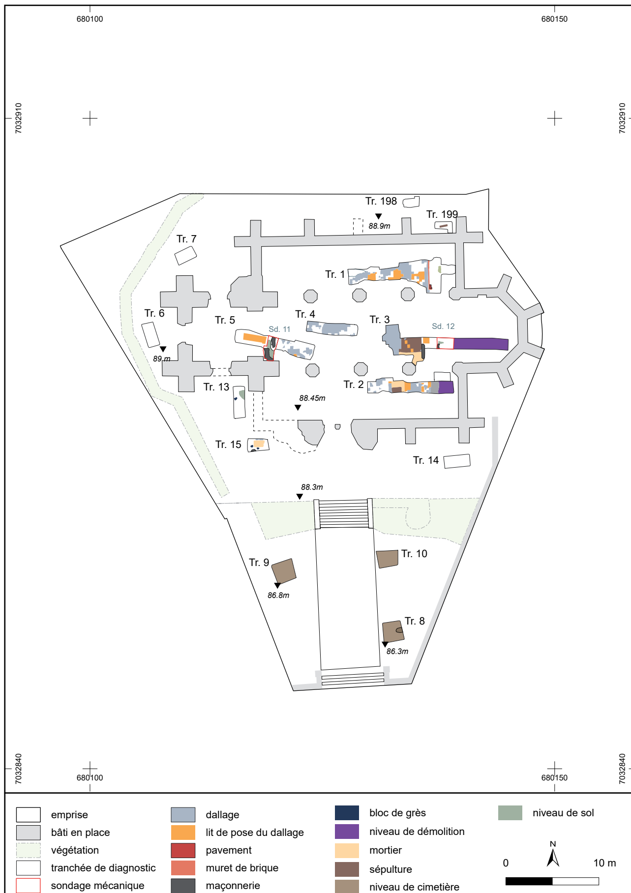
Fig. 17 : Ablain Saint-Nazaire, ruines de l'ancienne église, emprise du diagnostic avec localisation des tranchées, L. Wilket - DA, CD 62.
